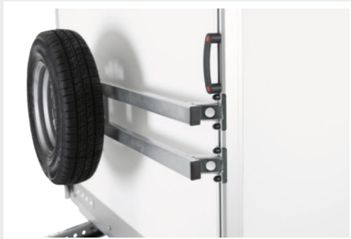
Reling mit Grundträgern an Vorderseite beliebig verschiebbar
